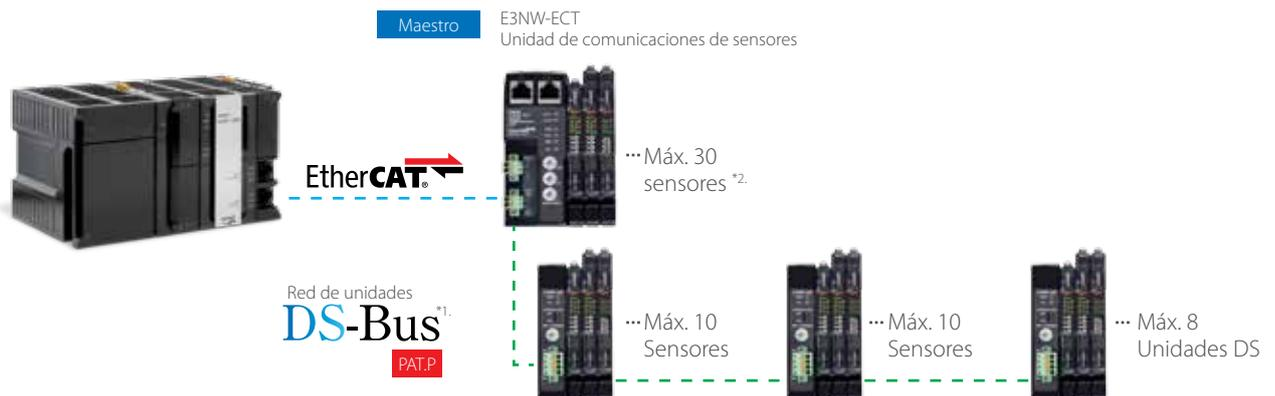
\*1 DS-Bus es un protocolo de comunicaciones de red entre unidades OMRON que conecta la unidad de comunicaciones entre sensores E3NW-ECT y las unidades distribuidas de sensores E3NW-DS.
